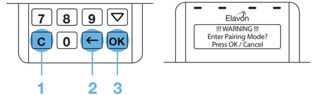
Aktivieren Sie jetzt am PIN Pad den Verbindungsmodus, indem Sie in schneller Reihenfolge die rote „Cancel“-Taste, die gelbe „Zurück“-Taste und die grüne „OK“-Taste wie angezeigt drücken. Alternativ können Sie alle drei Tasten gleichzeitig drücken, um den Vorgang zu starten.
